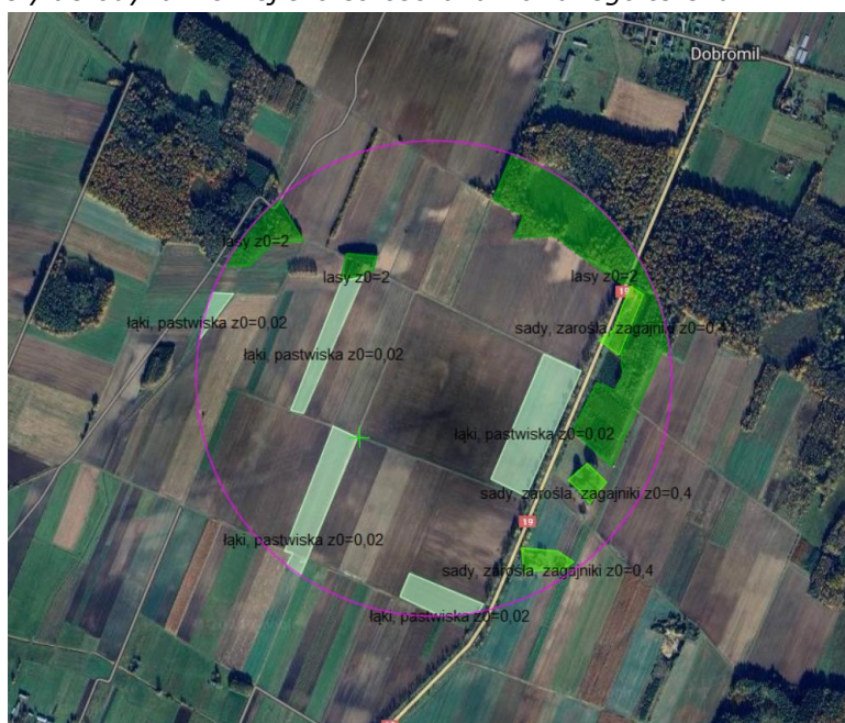
Rycina nr 32 Strefy aerodynamicznej szorstkości analizowanego terenu
